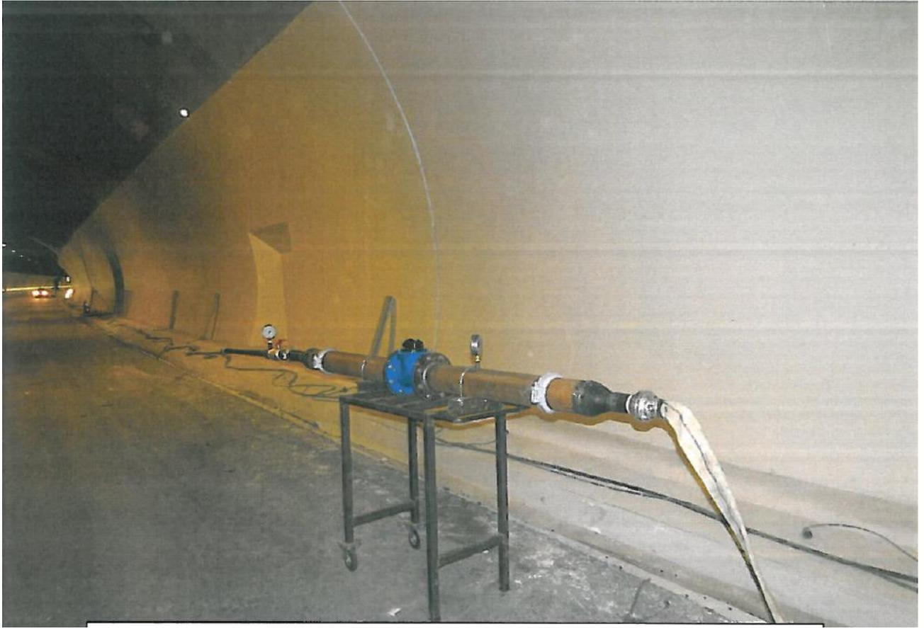
Σήραγγα Τ3 δοκιμές αντλιών πυροσβεστικού δικτύου
