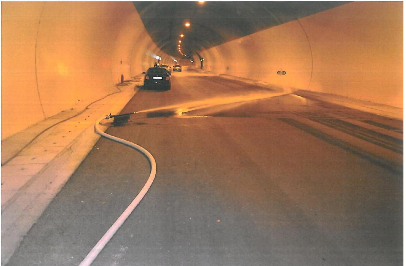
Σήραγγα T2 δοκιμές αντλιών πυροσβεστικού δικτύου
